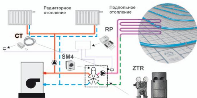
Смеситель **KANBloc** (ZTR), дополнительно оснащенный сервомотором (SM4), погодным регулятором (RP) и датчиками температуры (CT), реализуют автоматическое регулирование, например, в зависимости от наружной температуры.
