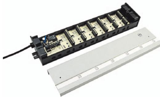
**Клеммная колодка Basic 230 В или 24 В, в версии с насосным модулем или без насосного модуля** - позволяет подключить термостаты и сервоприводы в одном месте (например, в монтажном шкафчике над распределителем). Можно подключить максимально 6 термостатов и 12 сервоприводов.
