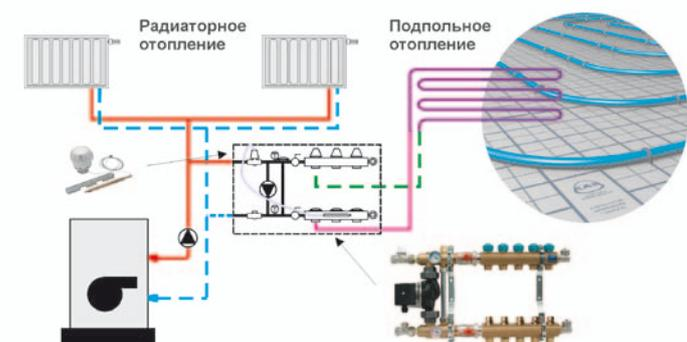
Распределители серии 73А и 77А подключаются непосредственно к радиаторному отоплению и представляют собой местную смесительную систему. Термостатическая головка с капиллярной трубкой играет роль защиты перед возможным ростом температуры, а также позволяет регулировать температуру, понижая ее от величины 55°C.
