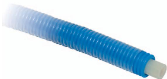
Труба PEX70 состоит из базовой трубы PE-Xc диаметра  $\varnothing 12 \times 2$  мм в защитной гофрированной оболочке из PE с размерами 18/14 мм (нар. диаметр/внутр. диаметр).
