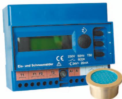
**Контроллер системы антиобледенения открытых площадок с датчиком снега и льда** - при взаимодействии с системой отопления защищает от обледенения, а также от залегания снега на коммуникационных трассах (лестницы в уличных переходах, тротуары, автостоянки, подъездные пути и т.п.). Датчик снега и льда может поставляться с проводом длиной 6 м или 20 м.
