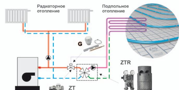
Смеситель **KANBloc** с четырехходовым вентилем (ZTR), дополнительно оснащенный термостатическим вентилем (ZT) и головкой с контактным датчиком (G), реализуют полуавтоматическое регулирование.
