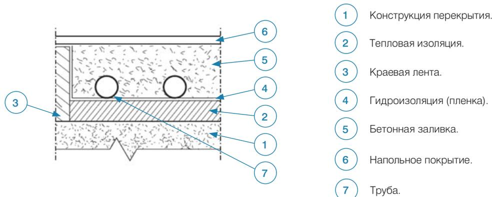
Подробные требования к греющим плитам (монолитным бетонным полам) описаны в инструкции "Система **KAN-therm** - напольное отопление, укладка мокрым методом". в инструкции "Система **KAN-therm** - напольное отопление, укладка мокрым методом".
